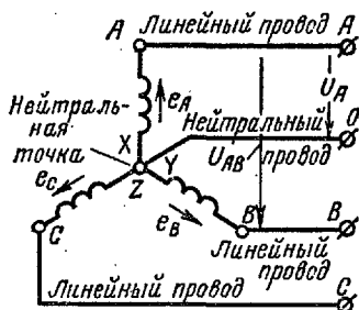
Рис. 12-4. Схема соединения обмоток генератора звездой.
