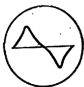
Рис. 8-25. Кривая исследуемого напряжения на экране осциллографа.
